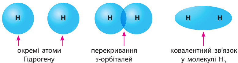
Мал. 6.1. Електронні орбіталі (1s) окремих атомів Гідрогену та в молекулі водню
