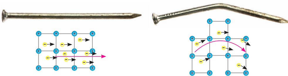
Мал. 8.3. Вільні електрони, неначе тісто, скріплюють металічні катіони незалежно від просторової форми металевого виробу, що зумовлює можливість надання будь-якої форми металічним кристалам
